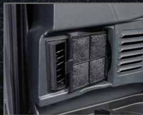
Filtre à air intérieur de climatisation
