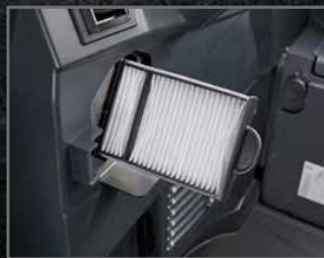
Filtre à air extérieur de climatisation
